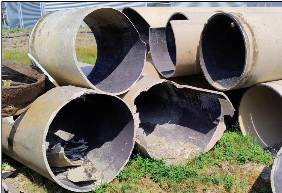
Abb. 3: Schadhafte, ausgebaute Rohrsegmente der 700er Druckrohrleitung
